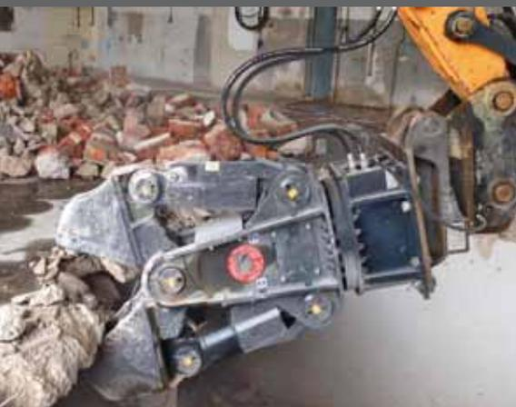
*Zwei großdimensionierte Zylinder leisten eine Schneidkraft von bis zu 430 t. Mit einer Öffnungsweite von 630 - 1.000 mm, je nach Modell, bleiben keine Wünsche offen.*
