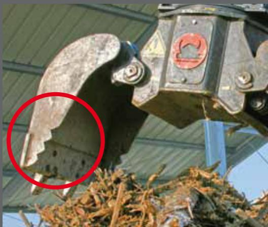
*Die komplett aus Hardox gefertigten Schalen sind äußerst verschleißarm und verwindungsstabil.*
