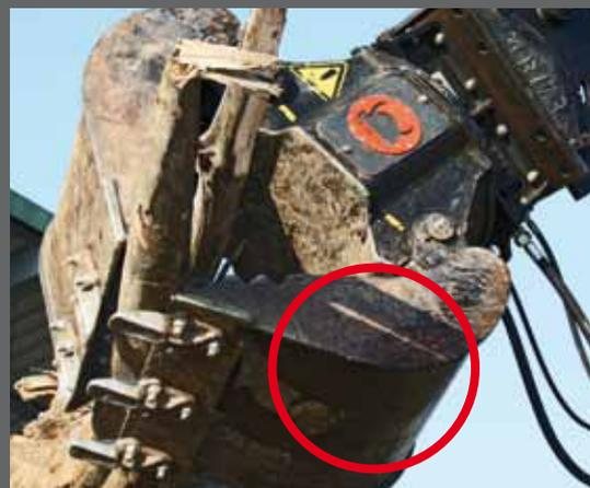
*Der Geräteboden ist rundum geschlossen. So wird die innenliegende Technik vor Beschädigungen durch Abbruchmaterial wie Eisen, Steine oder Hölzer geschützt.*
